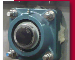
Todas las unidades cuentan con rodamientos Dodge y sellos de empaque para desperdicios
