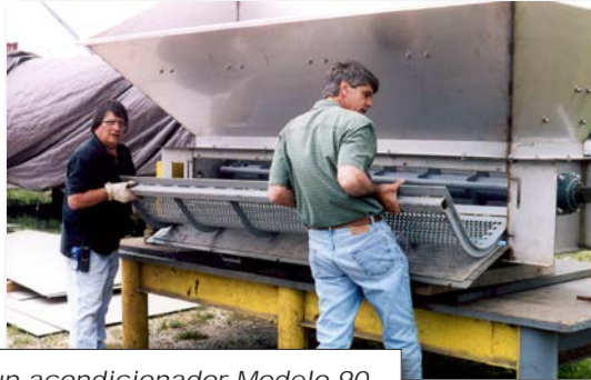
Extracción de la rejilla en un acondicionador Modelo-90
