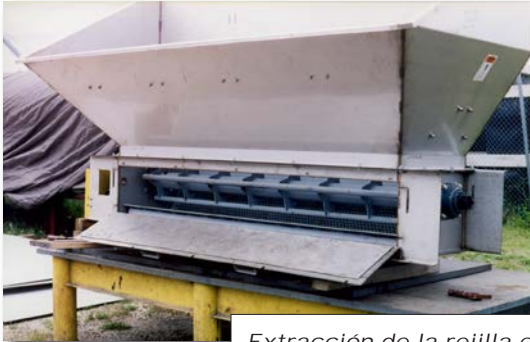
Extracción de la rejilla en un acondicionador Modelo-90
