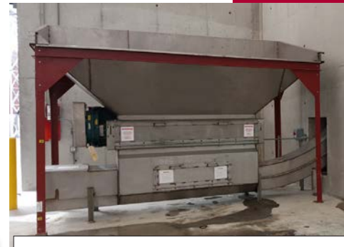
Sistema Fijo con capacidad para 300TPH
